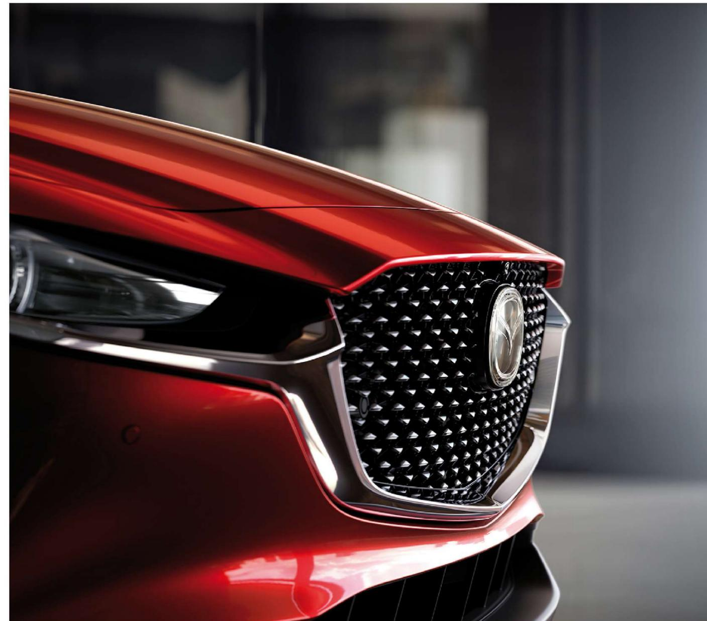
鳍板式外进气格栅 | 自动开闭式内进气格栅
